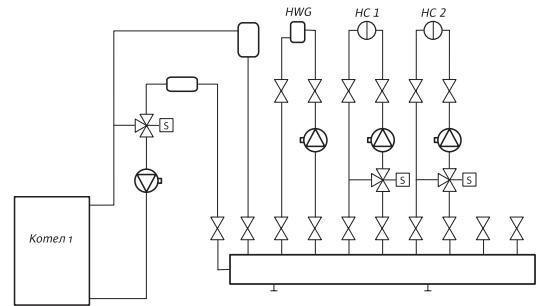
Насосы для системы подогрева воды (WWB) и нагревательных контуров HC 1 и HC 2 работают независимо друг от друга. Циркуляционные насосы предназначены только для преодоления возникающих в системе сопротивлений. Каждый из этих трех насосов последовательно подключен к циркуляционному насосу котла (KP). В задачи последнего входит преодоление сопротивления, возникающего уже в контуре котла.
