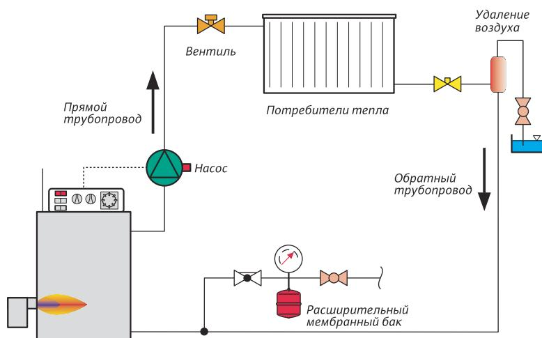
Для того, чтобы уменьшить потребление электроэнергии, необходимо, чтобы моторы насосов с мокрым ротором постоянно меняли частоту вращения. Частоту вращения можно менять вручную с помощью переключателей. Возможна также организация системы автоматики путем установки коммутационной аппаратуры и устройств управления, которые будут срабатывать в зависимости от времени, разности давлений или температуры.
