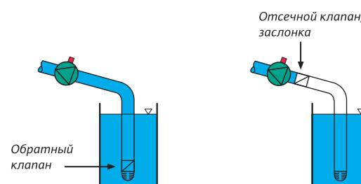
Установка с обратным клапаном или отсечным клапаном/заслонкой
