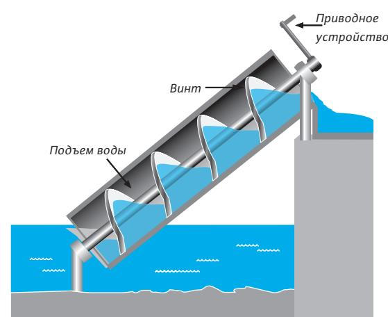
При этом принцип работы механизма был очень похож на тот, по которому работают современные центробежные насосы. Характеристика насоса имеет аналогичную зависимость между напором и подачей. Из исторических источников мы знаем, что такие винтовые насосы работали при углах наклона от 37° до 45°. Они обеспечивали подъем воды на высоту от 2 до 6 м и имели максимальную подачу около  $10 \text{ м}^3/\text{ч}$ .
