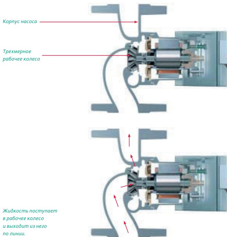
Насосы необходимы для перемещения жидкостей и преодоления сопротивления потоку со стороны трубопроводных систем. В случае насосных систем с различными уровнями жидкостей сюда также включается преодоление разности геодезических высот.
