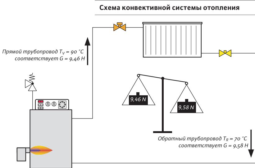
Движение воды вверх, а затем вниз осуществляется за счет разности плотностей теплой и остывшей воды.
