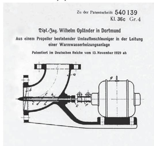
Колесо насоса в форме пропеллера было установлено в изгибе трубы. Оно приводилось в движение уплотняемым валом, который, в свою очередь, вращался двигателем.
