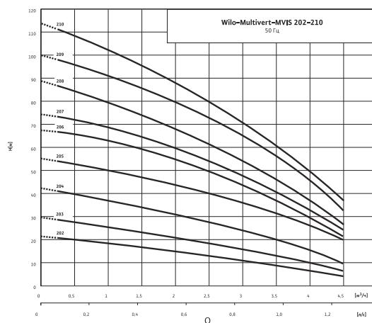
**Высоконапорный центробежный насос с мотором с мокрым ротором**
