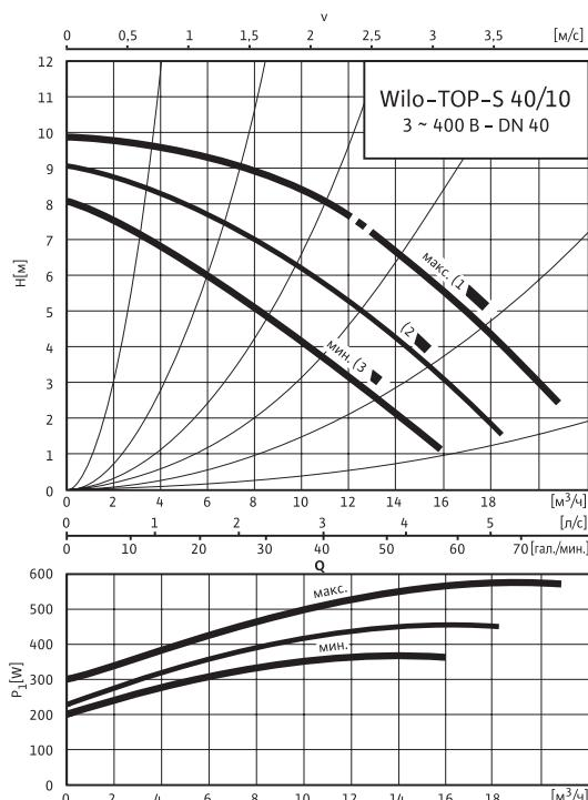
Чтобы частоту вращения моторов можно было изменять, в их конструкции использовались многосекционные обмотки. Если через трубопроводы системы отопления проходит небольшое количество воды, то сопротивление внутри труб низкое, поэтому насос может работать в режиме минимальной частоты вращения. Одновременно значительно уменьшается потребление электрической мощности.
