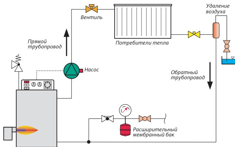
Потребители тепла — это поверхности нагрева, расположенные в обогреваемых помещениях (радиаторы, конвекторы, отопительные панели и т. д.). Тепловая энергия перетекает из точек с более высокой температурой в точки с более низкой температурой — и чем выше разность температур, тем интенсивнее тепловой поток. Эта теплопередача осуществляется посредством трех разных физических процессов:
